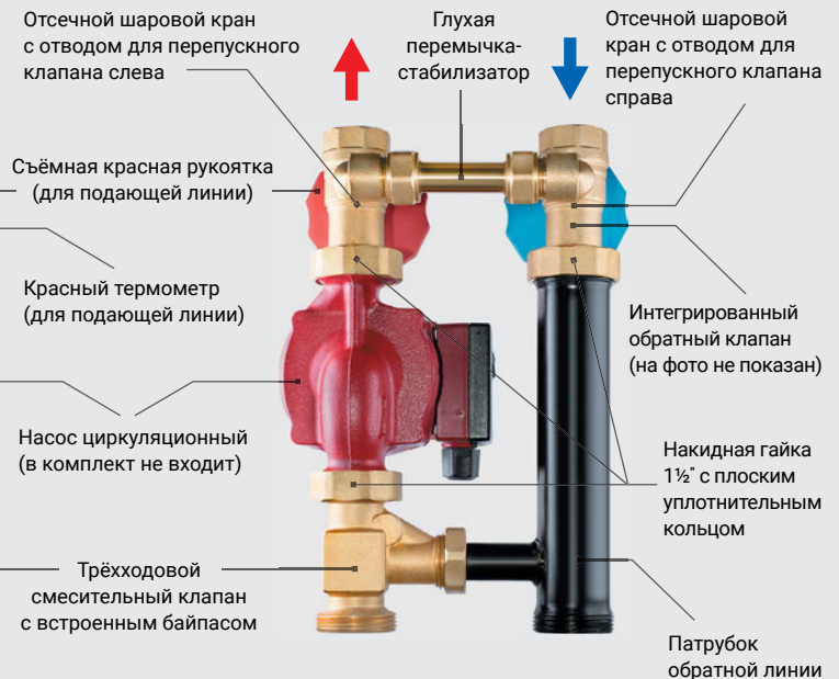
Вид сзади без теплоизоляционного кожуха
