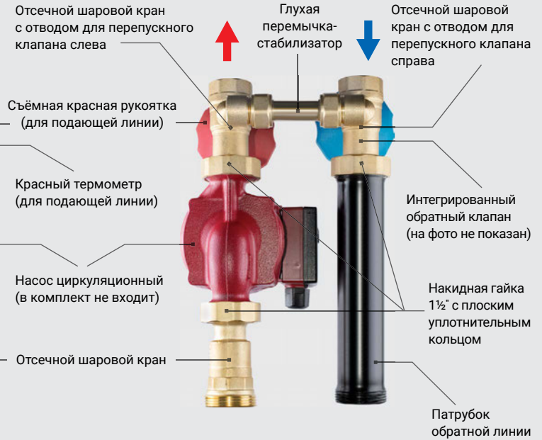
Вид сзади без теплоизоляционного кожуха
